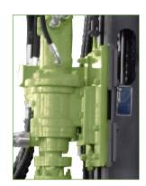
标配单马达回转头,回转速度 最高可达 150 转 / 分钟,满足 了部分客户对软岩层高速钻孔 的需求。
