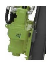
采用双马达回转,增大回转扭 矩和转速,使钻机在各种岩层 条件下使用自如,轻松应对卡 钻
